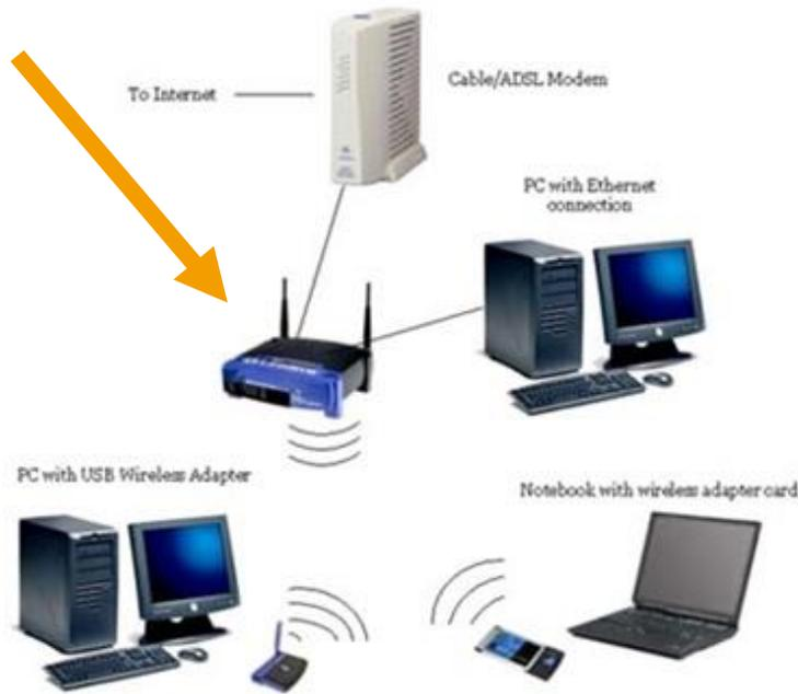
في هذا النوع يستخدم جهاز راوتر **Router** للربط بين الأجهزة المتصلة بالشبكة لأنه يتيح إمكانية الاتصال اللاسلكي بعض المحول السابق **Switch**، ويجب أن تتوفر خاصية الاتصال اللاسلكي على كل جهاز للربط بالشبكة أو يمكن استخدام جهاز اتصال لا سلكي بالأجهزة التي لا تتضمن هذه الخاصية خارجياً عن طريق منفذ **USB** الخاص بالجهاز.
